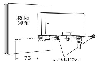
付属の木ねじは15mm厚の盤用木板(ベニア合板)用です。他の材質面へ取付ける場合は適切なねじをご使用ください。
