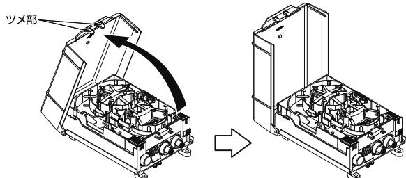
ツメ部をはずし、上へゆっくり持ち上げてください。カバーの開度は2段階構造になっています。カバーを閉める際は、ファイバー、電源コードを挟まないように十分注意してください。
